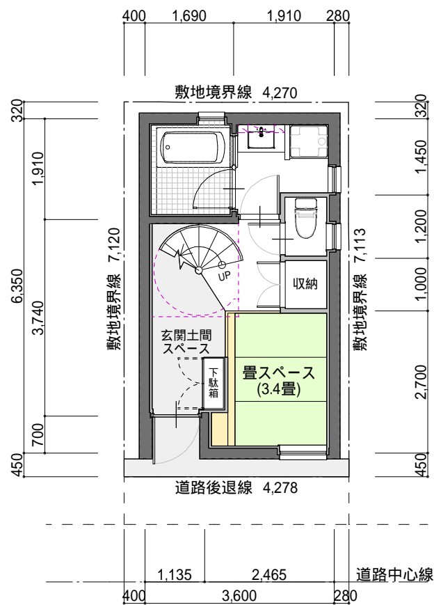
配置・1階平面図 S=1/100
